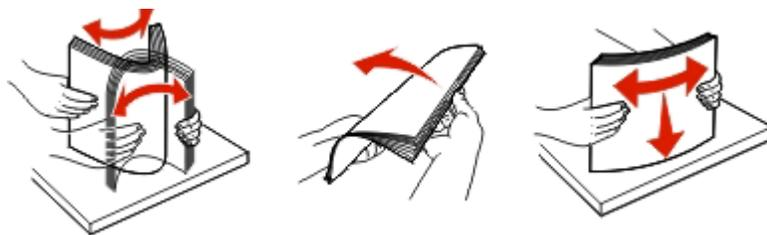
**5** 如图所示，将纸堆对着进纸匣的后部放入，并让推荐的打印面朝下。
